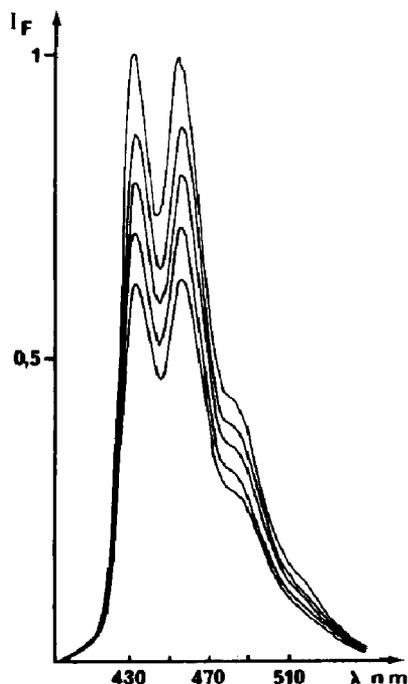
Fig. 2. Inhibition de la fluorescence d'une solution d'ACA ( $10^{-5}$  M; solvant, 10% éthanol-90% eau) par l'histidine. La longueur d'onde d'excitation est  $\lambda = 400$  nm.
